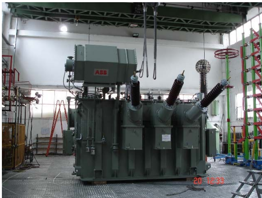
Abbildung 3.2: Netzkopplungstransformatoren 110kV/20kV (ABB) [3]
