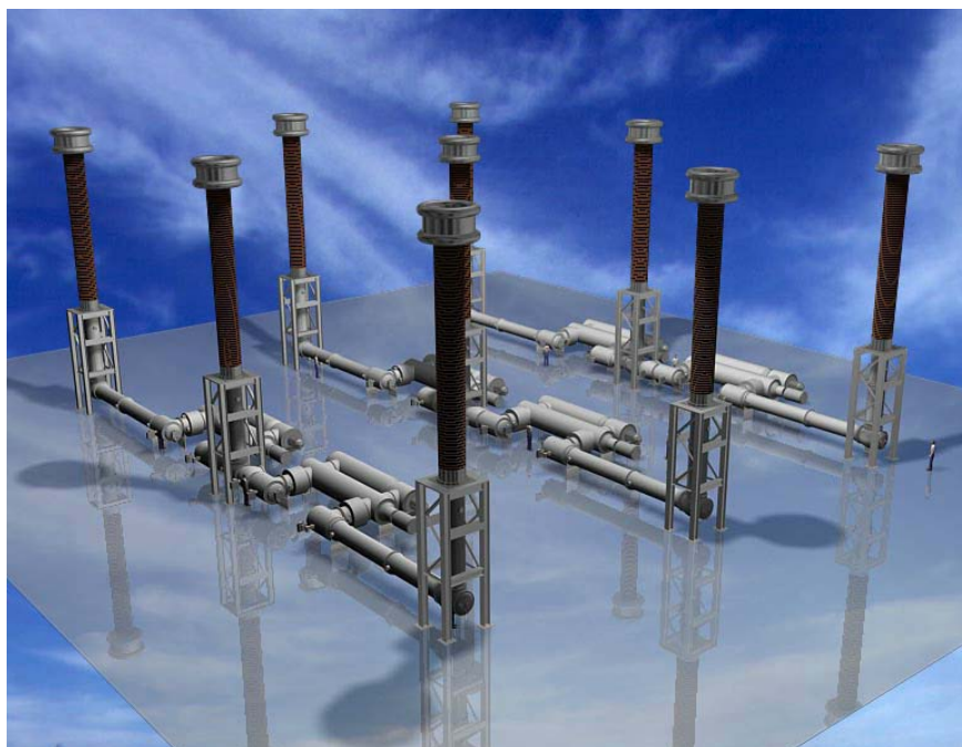
Abbildung 7.5: gasisolierte Hochspannungsschaltanlage (1100kV) ELK-5 (ABB) [31]
