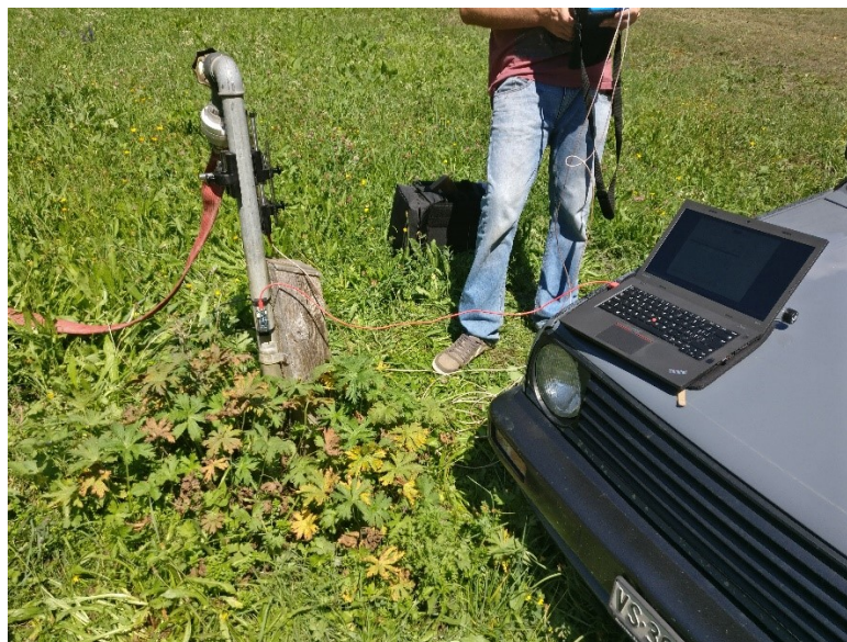
Figure 46 : Montage du prototype sur une canne d'arrosage.
