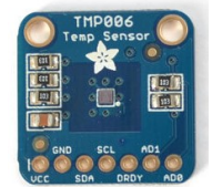
Figure 23 : TMP006 avec sa carte d'adaptation.
