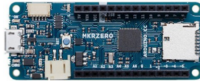
Figure 25 : Carte de développement Arduino MKR Zero.
