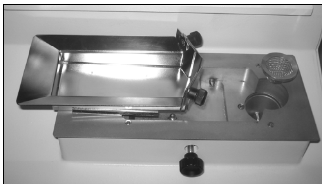
Image 7 Récipient vibrant et panier de récupération d'agrégats du Scirocco 2000
