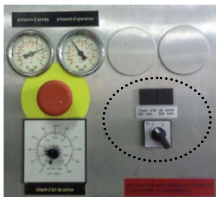
Image 6 Dispositif de commande du clapet d'air (ici en manuel)
