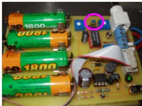
Photo 8 : Carte électronique final et le condensateur dans le cercle rose
