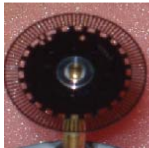
Photo 1: Disque à trous intégré sur l'axe de la roue à freiner
