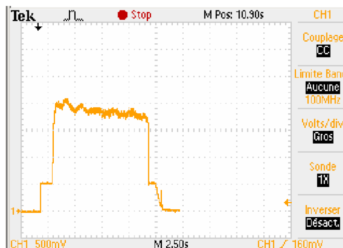
Graphique 45: Allure de la vitesse d'une roue alu vidée freinée (mesure 2)
