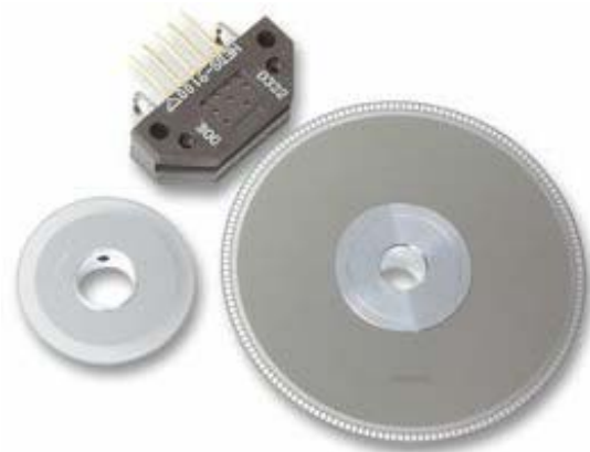
Photo 5 : Capteur incrémental et roues codeuses
