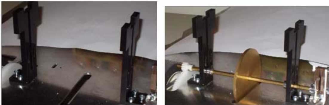
Photo 8: Axes interchangeables et leurs équerres de fixations
