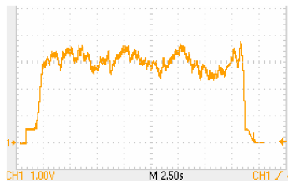
Graphique 8: Montage roue pleine alu, pente 6% et un aimant
