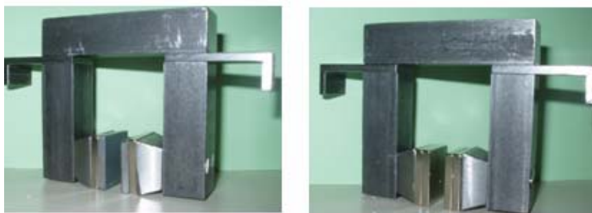
Photo 9 : Montage du circuit magnétique avec un aimant et deux aimants
