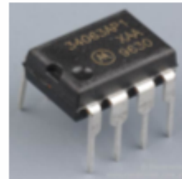
Figure 15 : Elévateur MC34063A et son schéma interne
