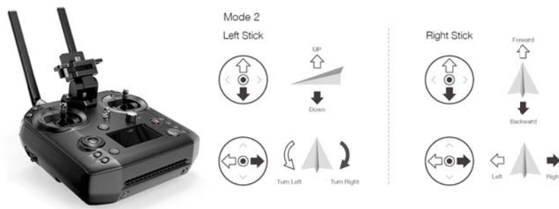
FIGURE 8: Télécommande Cendence et mode de pilotage 5
