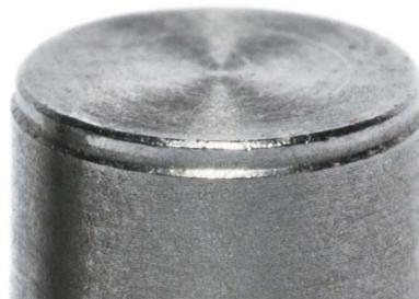
Figure 26: évidement du plongeur
