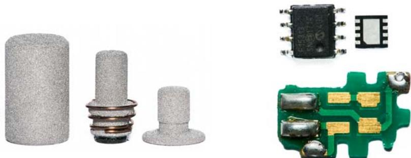
Eine der untersuchten Lösungen ist, die akustische Impedanz sowie das Gewicht mit Hilfe der Pulvertechnologie zu ändern.
