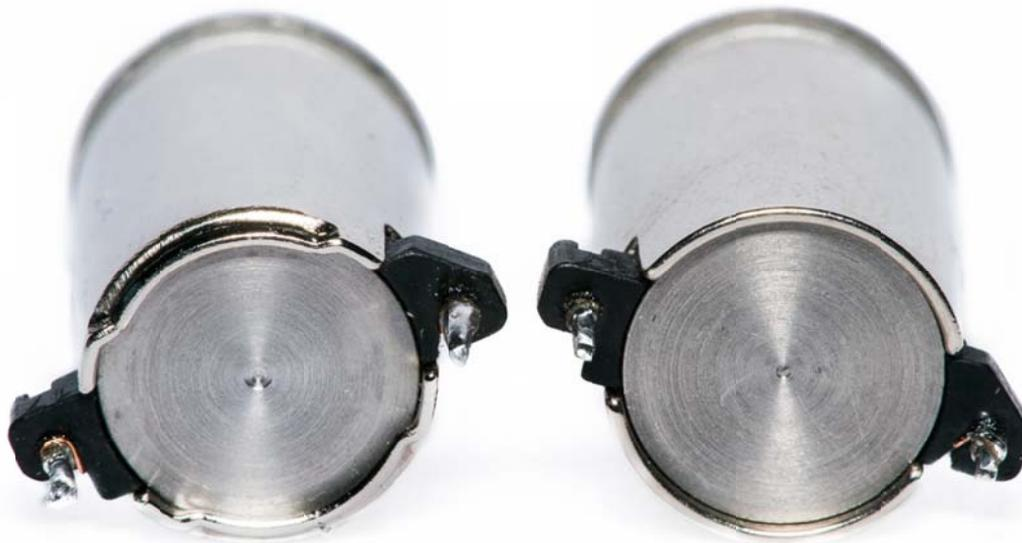
Figure 130: tube roulé et tube non roulé
