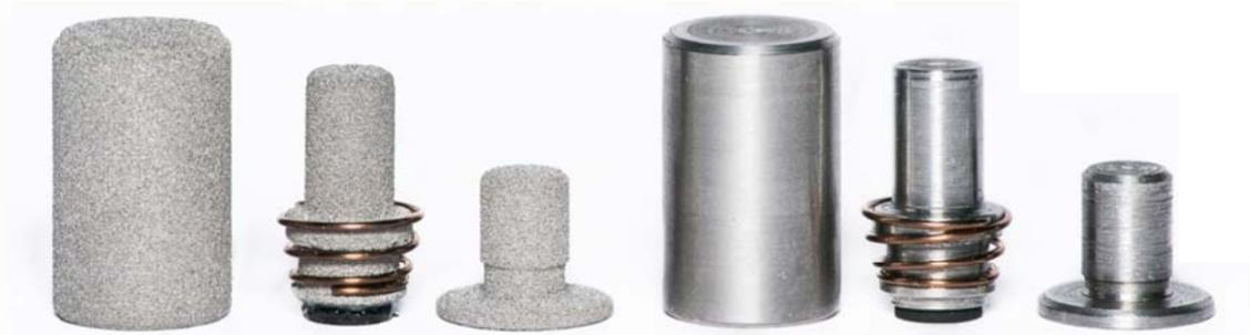
Figure 123: pièces en poudre et pièces pleines en acier 420
