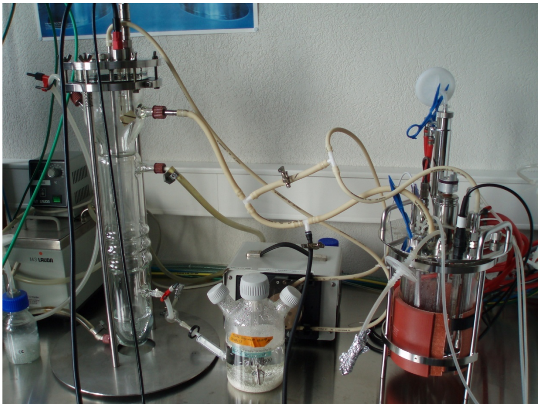
Figure 13 : installation FBR-STR montée prête pour commencer une culture avec les carrier dans le Spinner Flask
