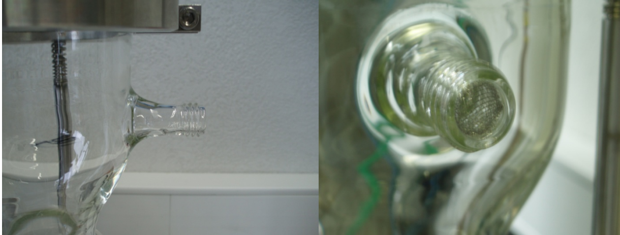
Figure 10: Sortie du FBR sans et avec la toile en acier taille des mesh 1 mm
