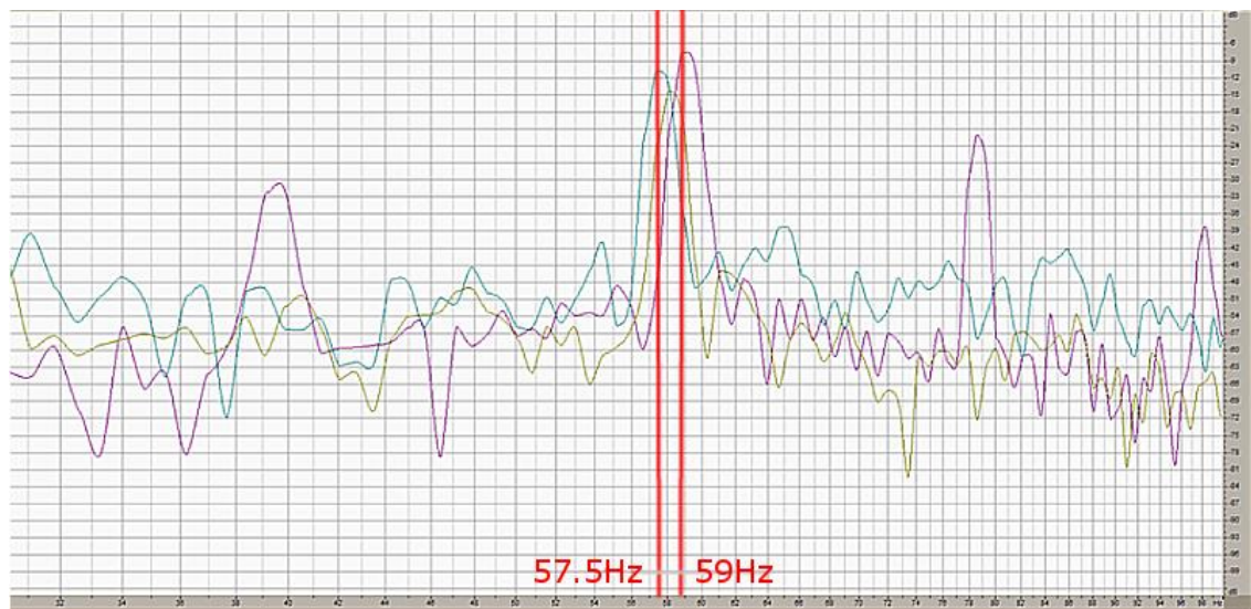
Figure 6 : Les courbes (points 2, 7 et 12) après FFT montrent l'évolution des harmoniques
