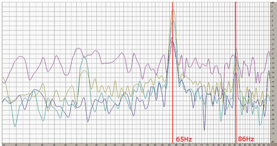
Figure 4: Les courbes (points 1, 2,3 et 4) après FFT montrent une unification des harmoniques à 65Hz et 86Hz
