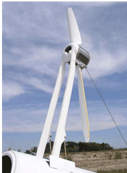
Figure 2 : système de propulsion de l'Antares
