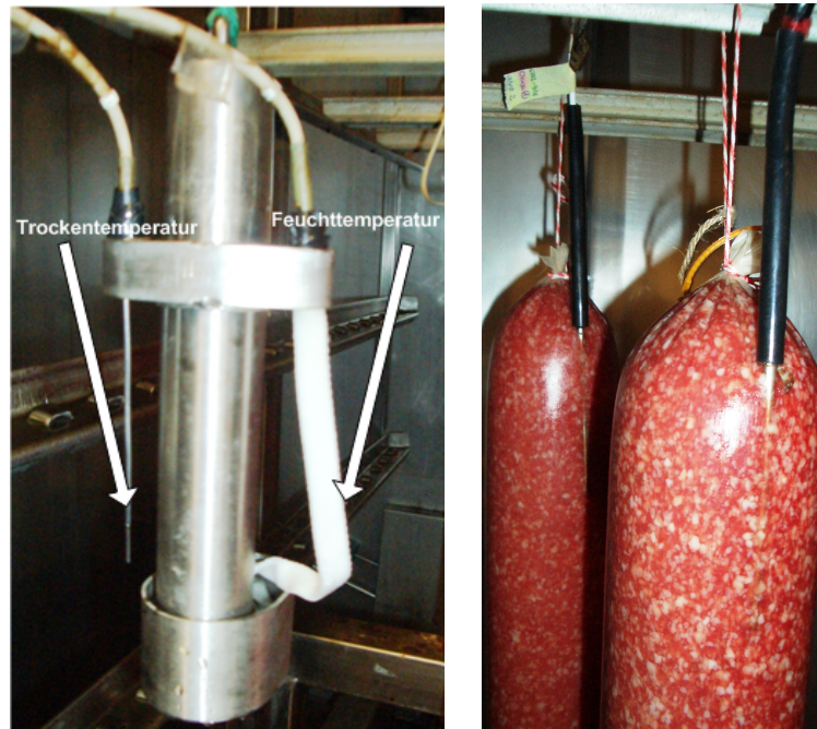
Abb. 3.5: Links: Messvorrichtung zur Ermittlung der Trocken- und Feuchttemperatur; Rechts: Anbringen zwei Temperaturfühlers zur Bestimmung der Oberflächentemperatur der Würste
