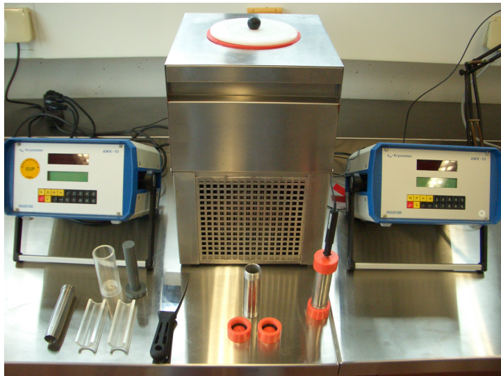
Abb. 3.4: Messvorrichtung zur Ermittlung der Wasseraktivität. In der Mitte links ein Messgerät, daneben das Kältebad und in der Mitte rechts wieder ein Messgerät. Unten von links nach rechts; Probenausstanzer, Einfüllwerkzeuge (4 Teile), Spachtel, Probenbehälter mit 2 Verschlusskappen und eingefüllter Probenbehälter mit eingestochener Pt-100 Temperaturmessfühler.
