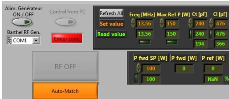
Figure 24 : Page Labview pour le contrôle l'alimentation MHz
