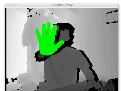
Bild der erkannten und ausge- werteten Hand, beziehungsweise Geste
