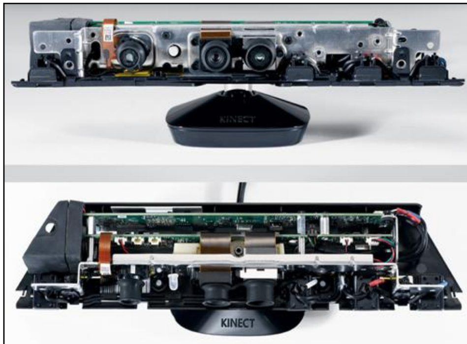
Abbildung 2: Kinect-Sensorsystem Innenansicht [19]
