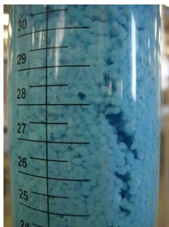
Figure 49 : fissures dans le lit fixe
