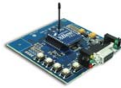
Abb. 3 : MaxStream XBee Pro Modul
