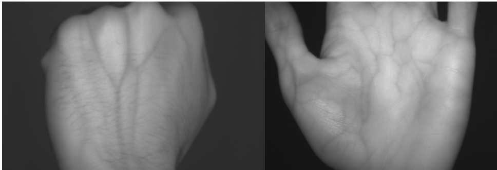
Figure 15: Image prise avec un filtre 830nm et LED 880nm, 1280x720
