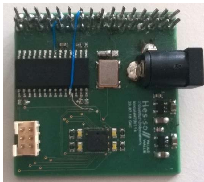
Figure 15 : Circuit caméra MT9V114
