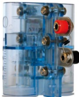
Figure 11: Pile à combustible réversible avec stockage de Heliocentris academia
