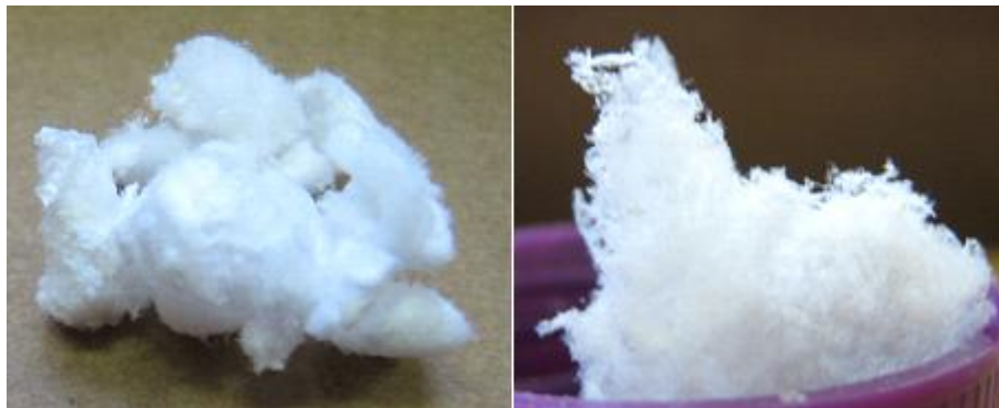
Fig.8: Derivatisierte \beta -Glukosidase nach Size exclusion Chromatographie und Lyophilisation
