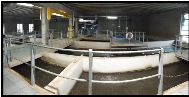
Figure 24 : Décanteurs primaires (4)
