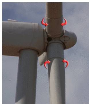
Figure 11 : Représentation schématique de la variation de l'angle de calage des pâles d'une éolienne.
