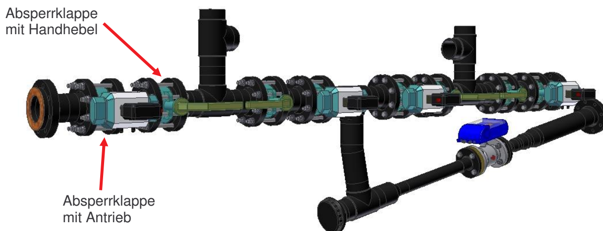
Abb. 36: Version 12 inkl. Absperrklappen mit Antrieb und mit Handhebel (Pumpgruppe 1)
