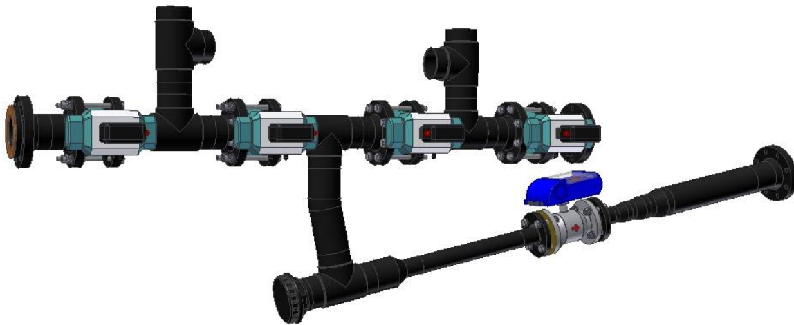
Abb. 32: Version 11 inkl. Absperrrklappen mit Antrieb oder mit Handhebel (Pumpgruppe 1)
