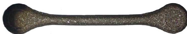
Figure 88: Corps fritté issu du Cycle n°4, Ti6Al4V, Four tubulaire, Frittage 5h à 1300°C, Sous vide puis Ar (série 6)
