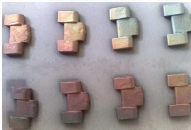
Figure 40: Craquelures des corps frittés en surface
