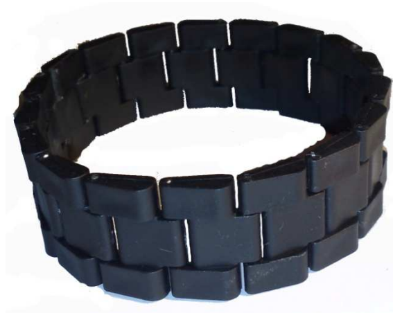
Figure 36: Montage des maillons en polypropylène avec les tiges d'accouplement
