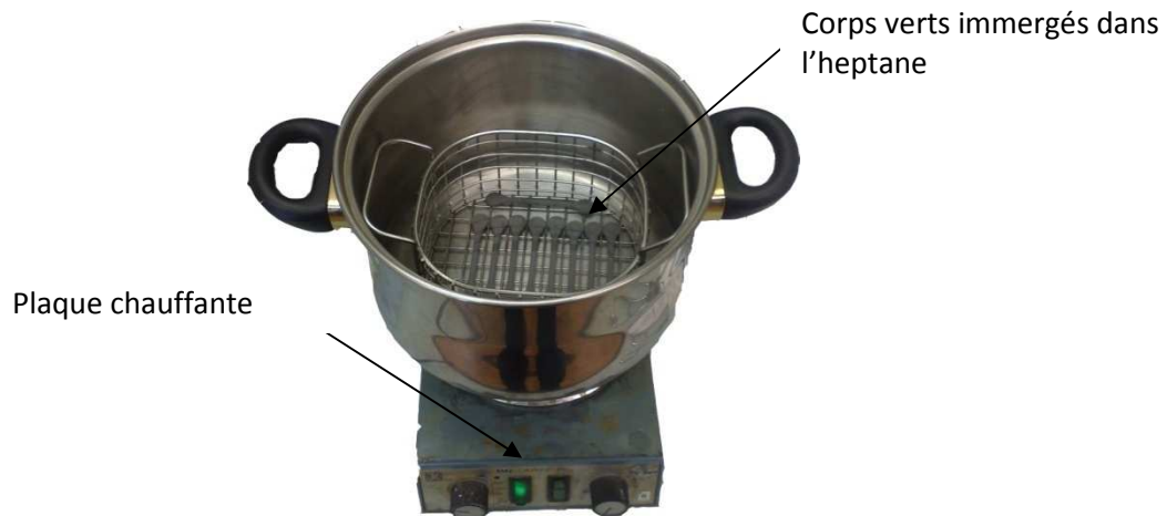
Figure 76: Déliantage des éprouvettes dans un solvant d'heptane
