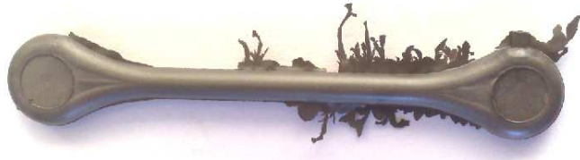
Figure 54: Flashing d'éprouvette lors de pression d'injection supérieure à 1000 bar
