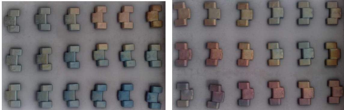
Figure 39: Aspect des corps frittés suite à une erreur de fonctionnement du four NABERTHERM
