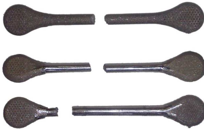
Figure 99: Rupture fragile des éprouvette lors de l'essai de traction (cycle n°3 à n°7)
