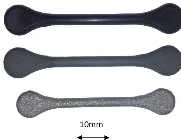
Figure 94: Retrait du corps fritté issu du Cycle n°5, Ti6Al4V, Four VHT, Frittage 3h à 1250°C, Sous vide puis Ar
