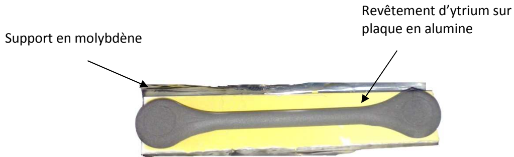
Figure 81: Corps brun en Ti6Al4V sur support en alumine revêtu d'yttrium
