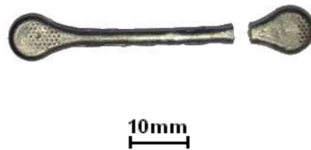
Figure 63: Rupture des éprouvettes en titane issu du feedstock TiH_2 lors des essais de traction
