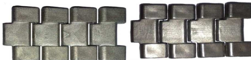
Figure 45: Tonnelage des maillons inox 316L pendant 48h (à gauche non tonnelée, à droite tonnelée)
