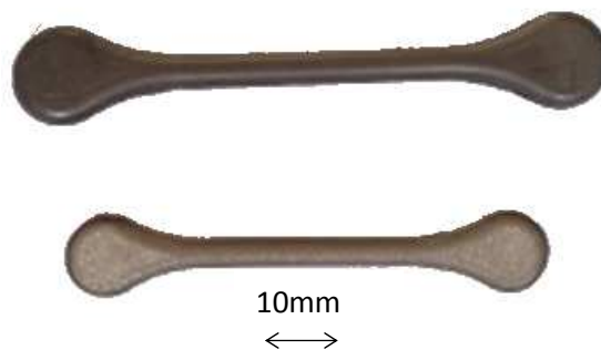
Figure 61: Retrait du corps fritté en titane
