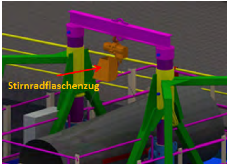
Abbildung 21: Hauptträgerbalken mit Turbine und Stirnradflaschenzug
