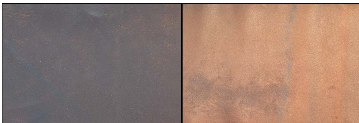
Figure 57 : face sup. de la barbotine F (à g.) et face inf. (à dr.), matrice 70% vol Cu et 30% vol C expansé
