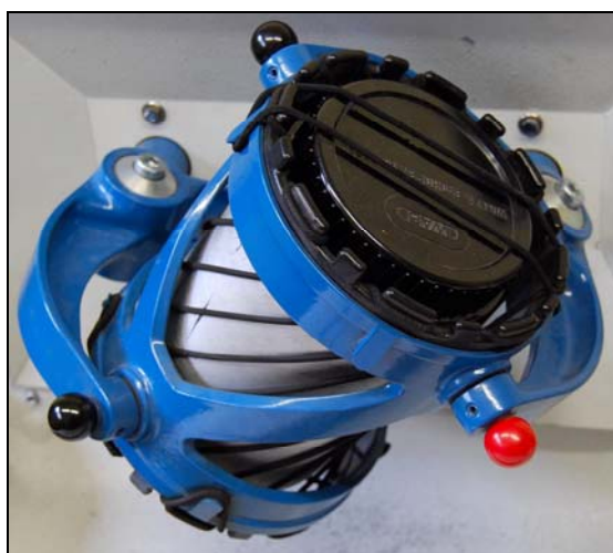
Figure 21 : mélangeur Turbula
