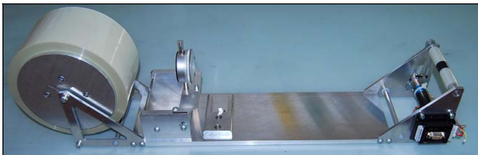
Figure 45 : appareil utilisé pour le coulage en bande
