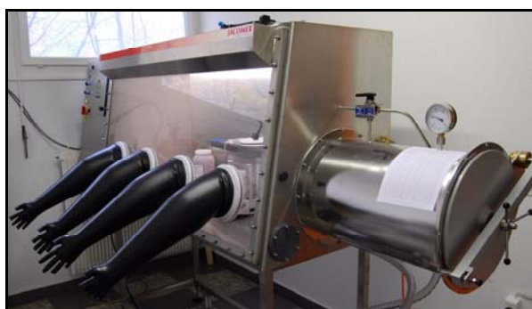
Figure 20 : boîte à gants Jacomex sous atmosphère protectrice d'Ar
