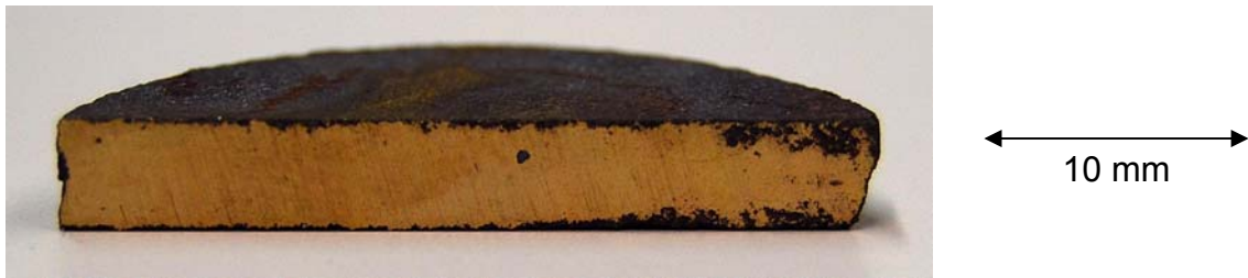
Figure 29 : coupe d'un échantillon CuAlNi avec 10% volumique de WC pressé à chaud
