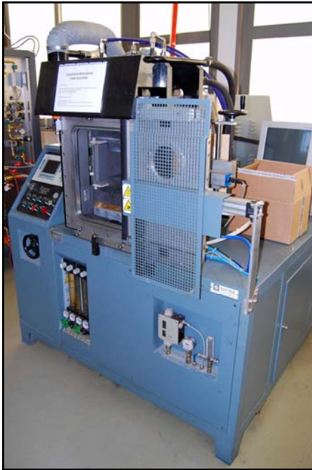
Figure 24 : presse à chaud (extérieur)
