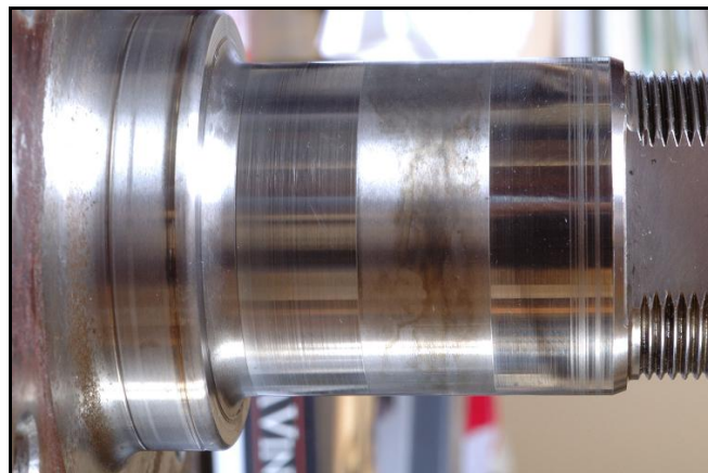
Figure 2 : conséquences de l'usure par abrasion
