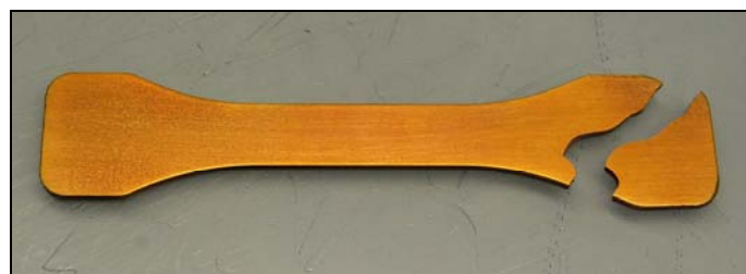
Figure 39 : éprouvette rompue après trempe à 20°C
