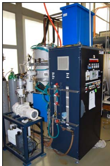
Figure 66 : four ECM ayant servi au déliantage
