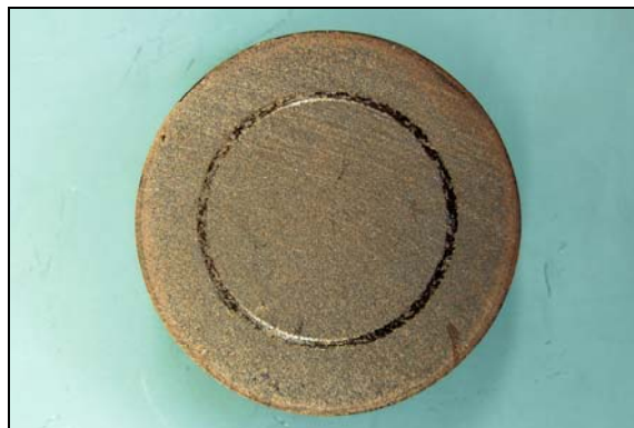
Figure 61 : échantillon 7, 70% vol Cu et 30% vol C expansé
