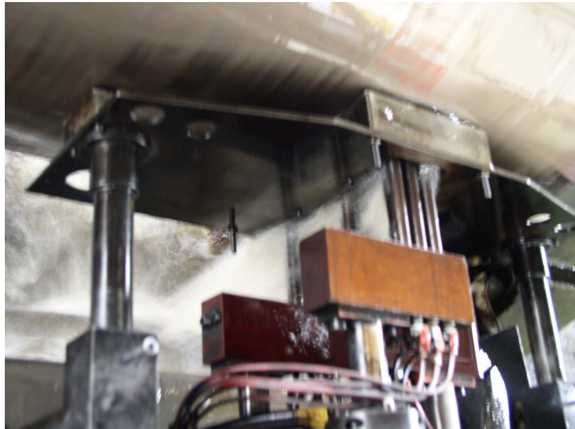
Abbildung 2 - Drei Elektroden-Köpfe mit je sechs Elektroden
