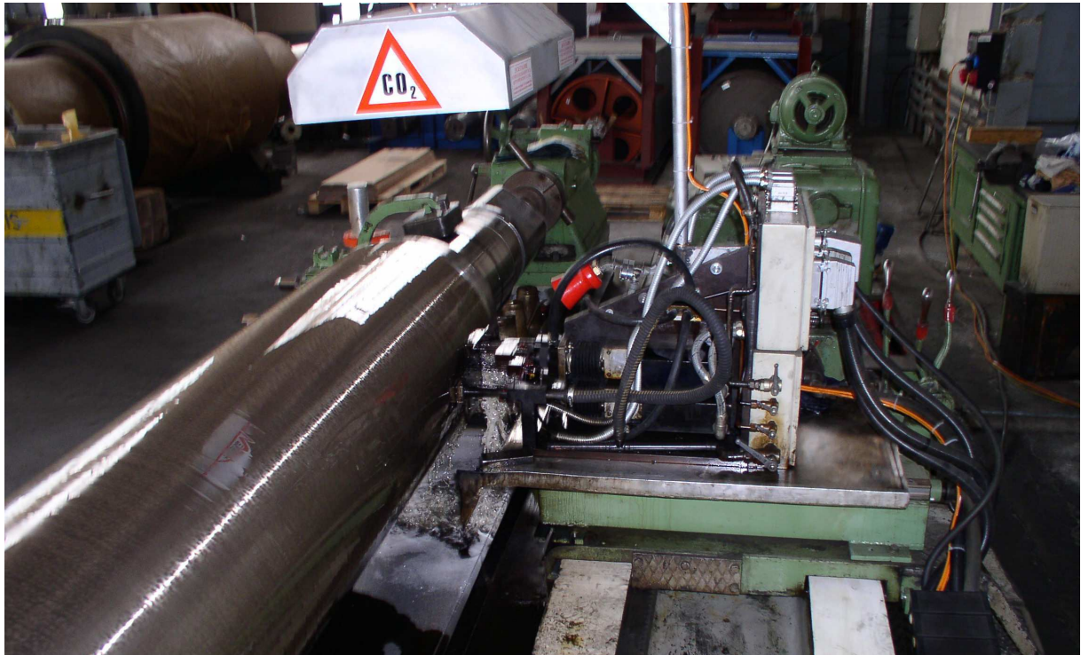
Abbildung 1 - Die EDT-Maschine mit Walze und Schlitten
