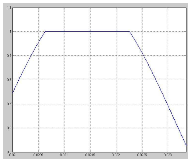
Figure 15.4 : Commande des switch de l'onduleur
