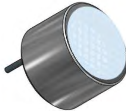
Figure 82 : Silicone sur l'émetteur ultrasonique
