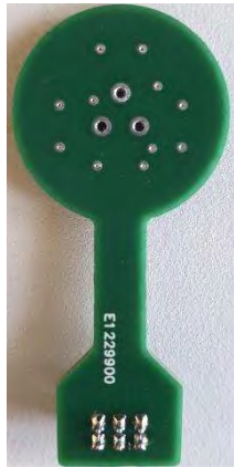
Figure 38 : PCB microphones V2.0 : Face arrière
