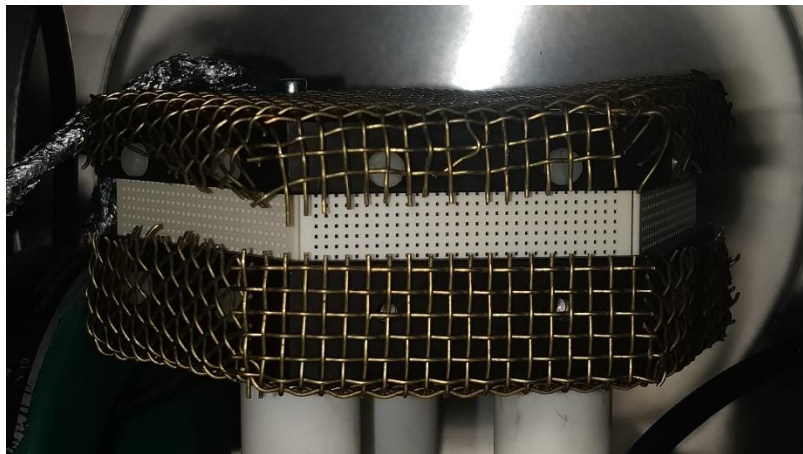
Figure 10 : Réacteur de 10mm d'espacement inter-électrodes, avec chapeau en POM et grillages en laiton
