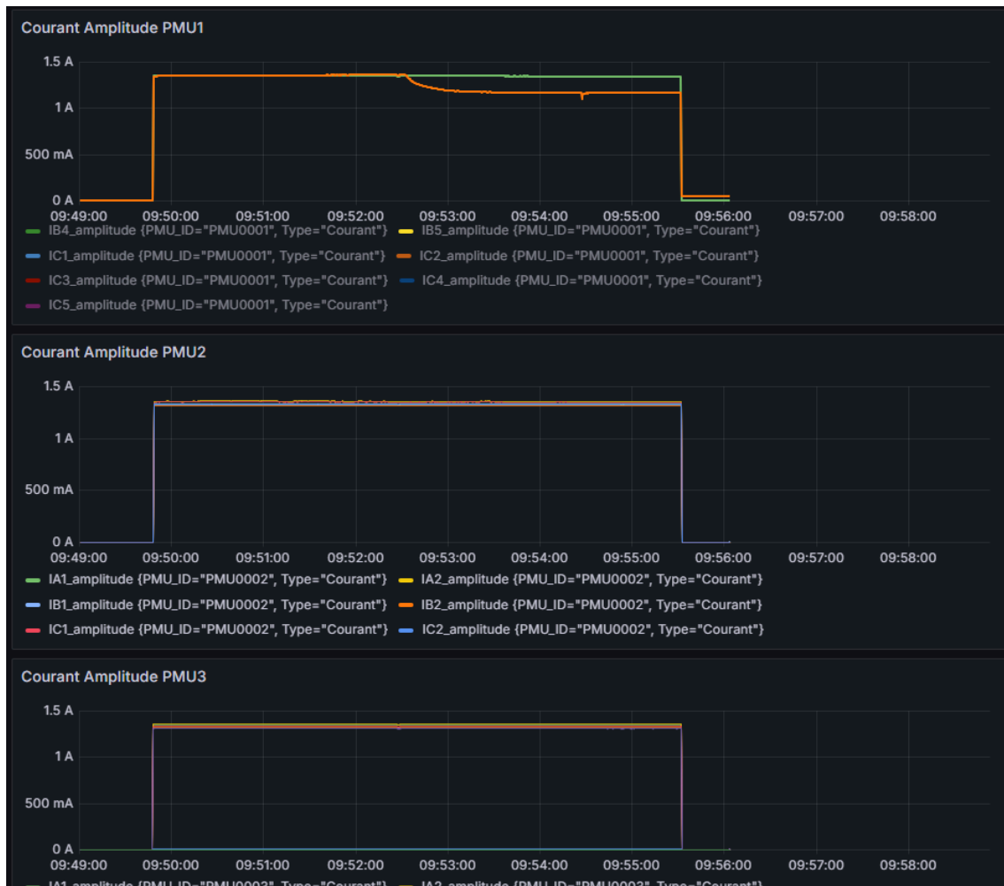
Fig. 19. – 2 COMs reliés au V- des alimentations DC
