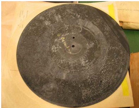
Dégradation d'un disque mécanique : blanchiment de la surface
