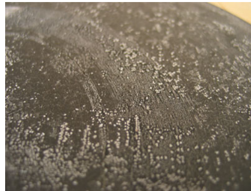
Dégradation d'un disque mécanique : blanchiment de la surface
