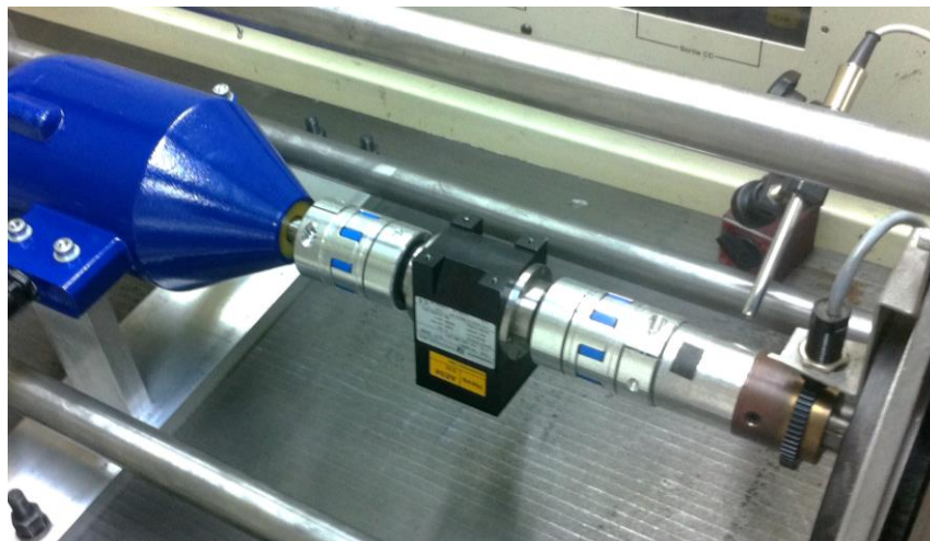
Figure 30 : Montage sur le banc d'essai avec le couple-mètre 2 N
