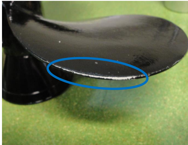
Figure 36 : Erosion en bout de pale
