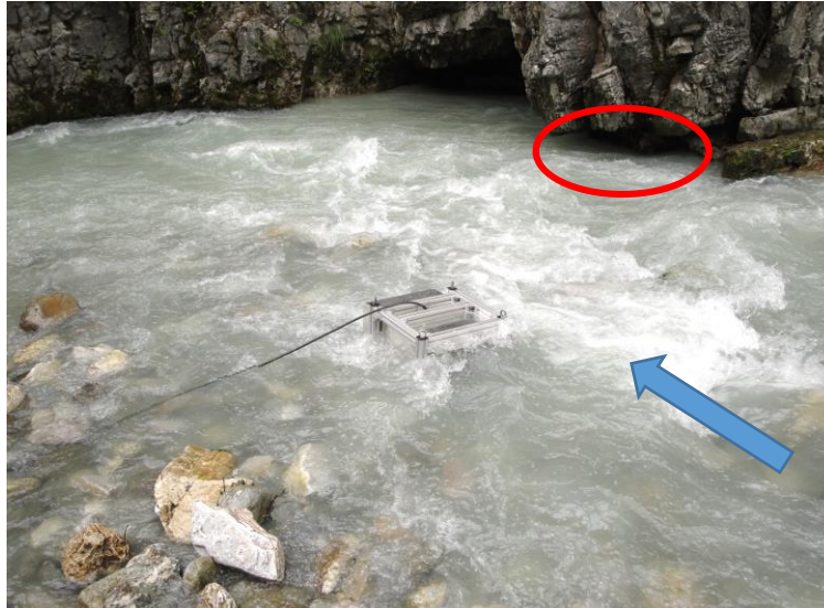
Figure 35 : Emplacement de la turbine en amont pour les mesures
