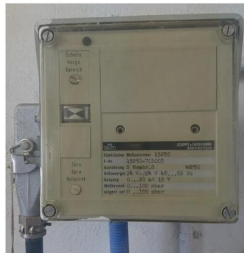
Figure 38: Capteur de pression
