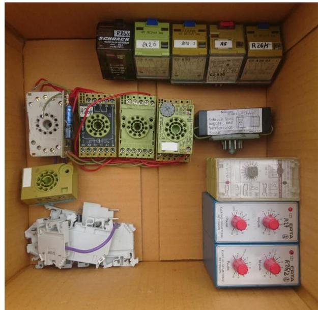
Figure 60: Composants démontés et remplacés par l'automate
