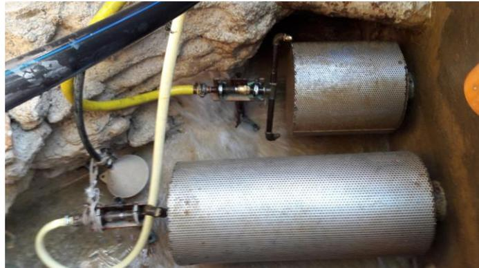
Figure 15: Dégrilleurs dans le bassin
