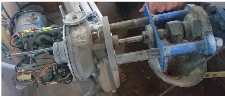
Figure 46: Servomoteur de l'injecteur de la turbine 1
