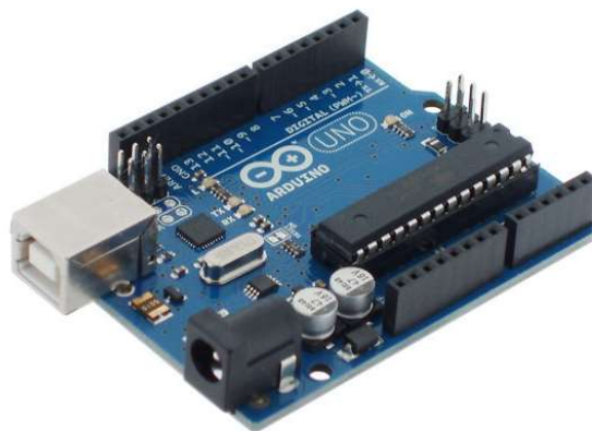
Figure 19 : Carte programmable Arduino Uno R3
