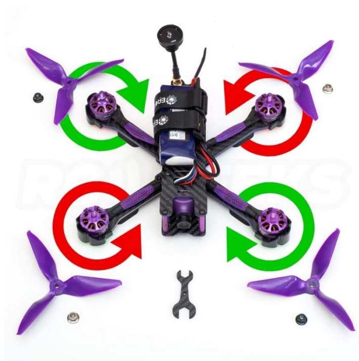
Figure 3: Sens de rotation des hélices, récupérée sur https://d2otfaypcda2dg.cloudfront.net/blog/wp-content/uploads/2017/08/Eachine-Wizard-X220-setup-propeller-installation2.jpg
