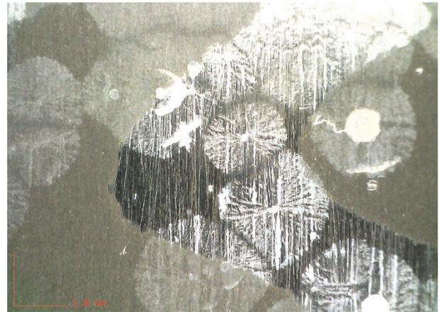
*Abbildung 12 Aufnahme der Oberfläche des Coupons 5.IP während der kalten Phase (18°C), wobei sichtbare Verfestigung der Kokosnussölbeschichtung in Form von Kreisen entstanden. 50x*
