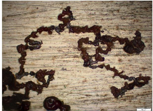
*Abbildung 21 Fadenförmige Korrosionserscheinung auf dem nicht beschichteten Pamorcoupon 1.IIP mit in sich zusammengefallenen Tropfen der Korrosion 100x*
