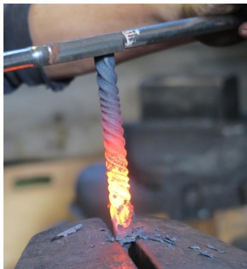
Um eine Musterung im Schweissverbundstahl zu erreichen, kann ein Stab zum Beispiel tordiert werden.
