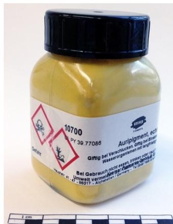
Abbildung 43 Das Auripigment von Kremerpigmente, welches für die Ätzungen der Coupons verwendet wurde
