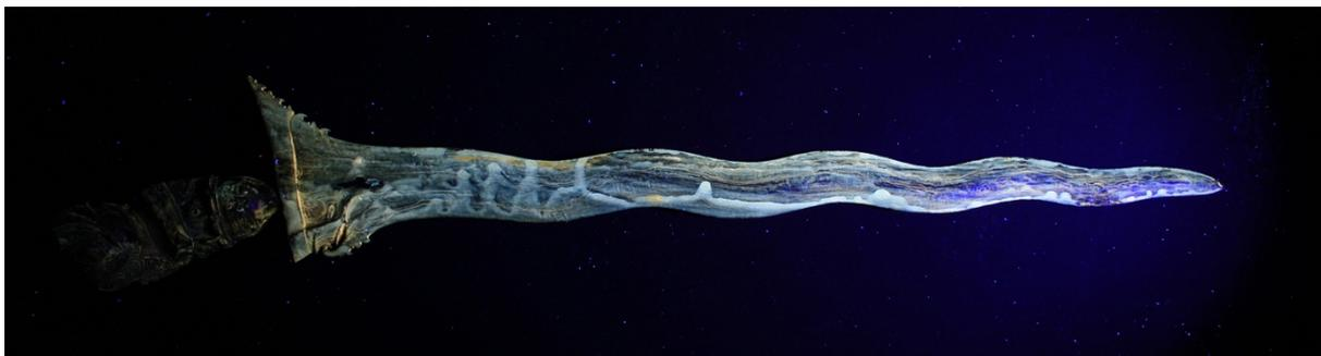
*Abbildung 6 UVF Aufnahme von Objekt 2 IIC 2118 mit klar sichtbaren Laufspuren des Beschichtungsmaterials*
