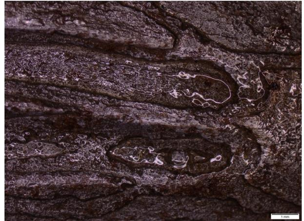
*Abbildung 62 Acrylbeschichtung auf Objekt 13. IIC 22217, 10x Vergrößerung © JM, HE-Arc / MKB 2020*
