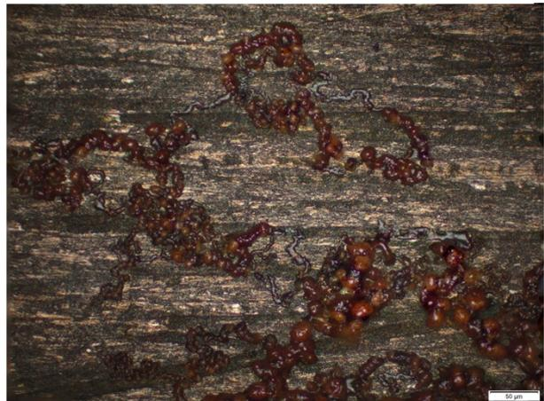
*Abbildung 30 Fadenförmige Korrosionserscheinung auf unbeschichtetem Pamorcoupon 1.IIP 200x*
