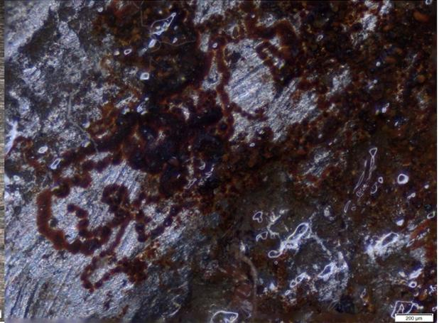
*Abbildung 69 filiforme Korrosionserscheinung auf Objekt 13. IIC 22217 mit Acryllackbeschichtung 45x*
