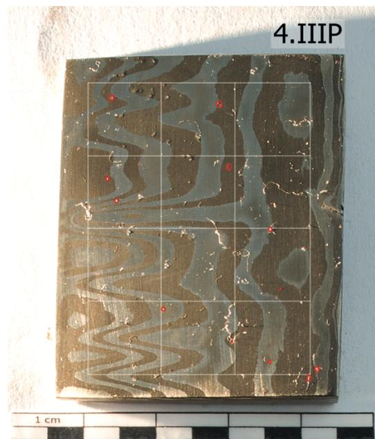
*Abbildung 29 Pamorcoupons 4.IIIP welcher auch nach den sechs Wochen in der Klimakammer sichtbar eine Beschichtung aufwies und geringere Korrosionserscheinungen (eingezeichnet in Rot), Streiflichtaufnahme*
