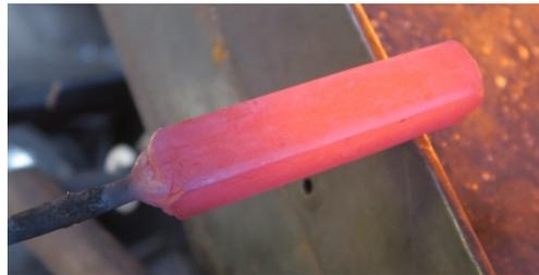
Man kann erkennen, dass eine Feuerschweissung erfolgreich war, wenn beim erneuten Erwärmen im Übergangsbereich von einem Blech aus Legierung1 zu einem Blech aus Legierung2 keine dunkle Linie zu erkennen ist, sondern ein gleichmässig glühender Block.
