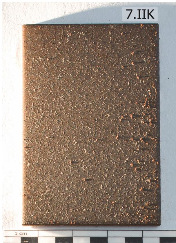
*Abbildung 60 vorkorrodierter Coupon 7.IIK mit verstärkten Korrosionserscheinungen im rechten Randbereich, Streiflichtaufnahme*
