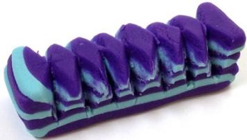
Aus den in die Länge verformten Schichten werden dreieckige Stücke entfernt. Dies entspricht dem Einfeilen von Mehrlagenstahl zur Erzeugung eines Musters.
