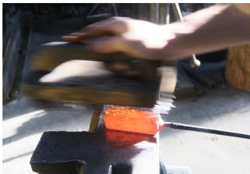
Abbürsten, um den Zunder und die Schweißmittelreste (Borax) zu entfernen.
