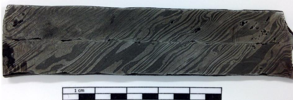
Abbildung 40 Pamormaterial mit einer Cosmoloid® H80 Beschichtung, links gesprüht und rechts mit einem Pinsel aufgetragen
