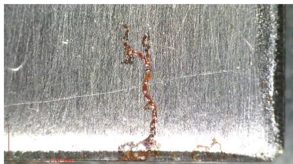
Abbildung 61 Coupons 3.IS mit filiformer Korrosionserscheinung vom Couponrand. 50x Vergrößerung
