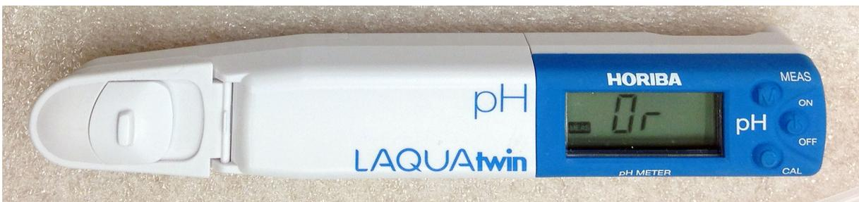
*Abbildung 20 pH-Wert Messgerät LAQUATwin, welches für die Messungen des pH-Wertes der Klingenoberflächen verwendet wurde.*
