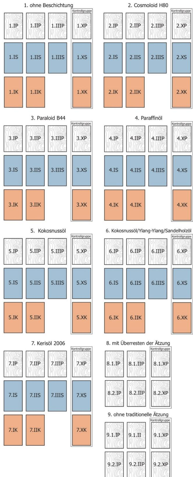
Abbildung 8 Visualisierung der Versuchssets 1.- 9. mit den unterschiedlichen Substraten, P = Pamorcoupons, S = homogene Stahlcoupons, K = vorkorrodierte Stahlcoupons
