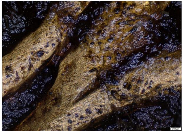
*Abbildung 63 Pastose Wachs-Öl-Beschichtung auf Objekt 4 IIC 14587 mit starken Verschmutzungen in der Beschichtung, 30x Vergrößerung © JM, HE-Arc / MKB 2020*
