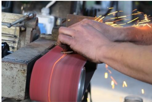
Aus dem entstandenen Schweissverbundstahl können Stücke geschnitten und angeschliffen werden. Das Muster kann entsprechend der gewählten Richtung des Anschliffs variieren.
