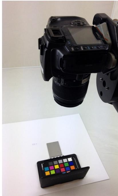
*Abbildung 58 Dokumentationsphotografie der Coupons mit Farbkarte für die normierte Farbgebung*
