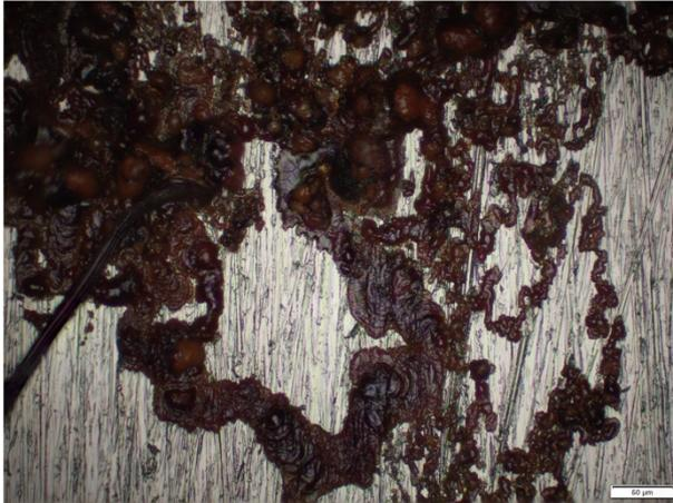
*Abbildung 25 Lokale gleichmässige Korrosionserscheinung auf Coupon 1.IIS welche in einigen Bereichen zu filiform gleicher Korrosion ausläuft 200x*
