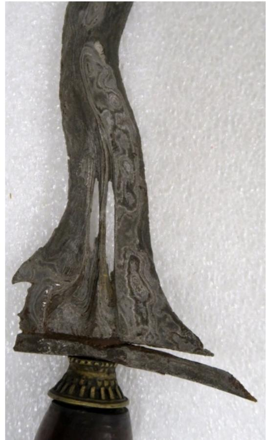
*Abbildung 21 Klinge des Objekts IIC 14299 (MKB) mit starken Durchbrüchen im Bereich der Verzierungen des Prabots*
