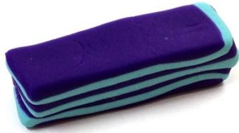
Gemeinsam werden die verschiedenen Lagen verformt. Die Verformung verläuft in die Länge. Dies entspricht dem in die Länge Schmieden der feuerverschweissten Bleche.
