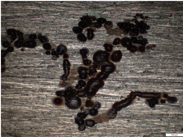
*Abbildung 18 Filiforme Korrosionserscheinung auf Stahlcoupon 3.IS mit Paraloid® B44 Beschichtung 100x*
