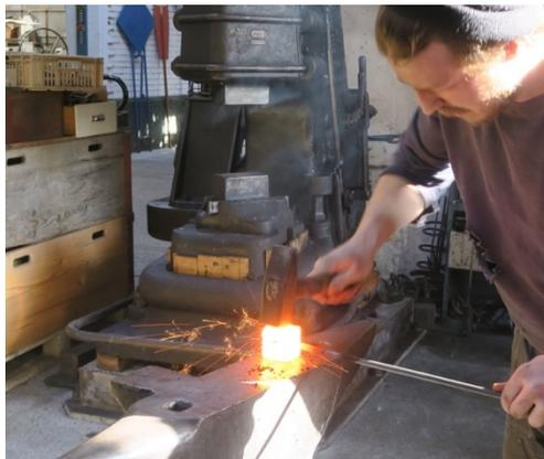
Wurde genügend Hitze erreicht, werden die hell glühenden Stücke mit einem Schmiedehammer auf dem Amboss zusammengepresst. Es muss von oben auf die Fläche eines Blechs geschlagen werden, so dass die zu verschweisenden Oberflächen zusammengedrückt werden. Dadurch entsteht eine unlösbare Verbindung der beiden Legierungen (Weihrauch 1995, S. 60).
