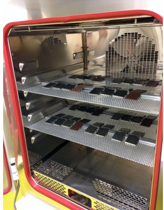
*Abbildung 50 Die Klimakammer (Vötsch Typ VC 0020) an der HKB mit den Coupons gruppiert und in einem Winkel auf den beiden Blechen angeordnet, vor dem Belastungstest*
