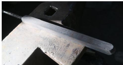
Durch das Schmieden in Längsrichtung werden die Schichten in die Länge gezogen und sind weiterhin parallel zu erkennen.
