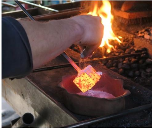
Erreicht das Material eine orange Farbe, wird gleichmässig Borax auf die Oberfläche des Blocks aufgestreut.
