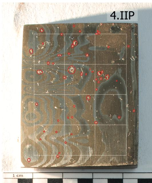
*Abbildung 28 Pamorcoupon 4.IIP welcher nach vier Wochen keine sichtbare Beschichtung mehr aufzeigt und verstärkte Korrosionserscheinungen entwickelt hat (eingezeichnet in Rot), Streiflichtaufnahme*
