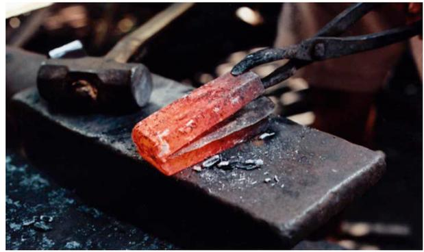
*Abbildung 7 Der Arbeitsschritt bei welchem das nickelhaltige Material in den Stahl eingelegt wird, welcher später die helle Lage bilden wird. © Weihrauch 2000*
