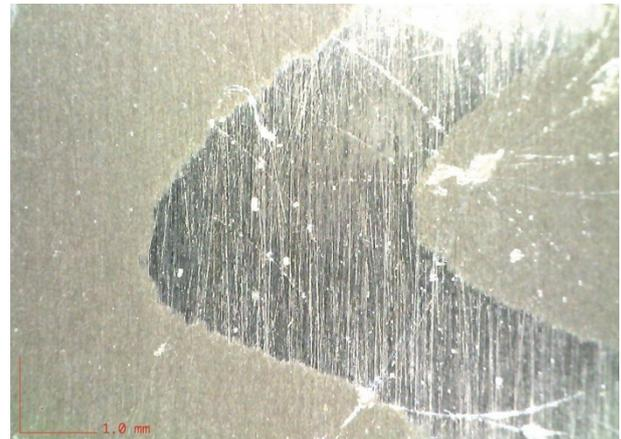
*Abbildung 13 Aufnahme der Oberfläche des Coupons 5.IP nach dem Belastungstest mit zentrierten Ansammlungen der Kokosnussölbeschichtung. 50x*
