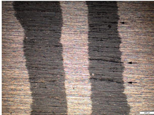
*Abbildung 9 Pamorcoupon mit Cosmoloid®H80 Beschichtung, welche nicht alle Tiefen der Schleifspuren bedeckt, sichtbar auf dunkler Phase (Pfeil) 50x*
