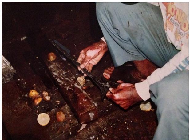
Abbildung 5 Ätzen von Kerisklingen mit Limettensaft und Warangan © de Marval 2006
