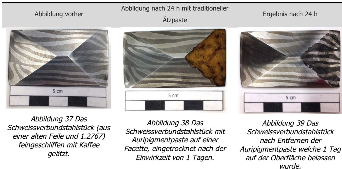
Das Schweissverbundstahlstück (aus einer alten Feile und 1.2767) wurde feingeschliffen und mit einer Kaffeelösung wurde das Muster sichtbar gemacht. Die Zitronen-Auripigment-Paste wurde lediglich auf einen Bereich aufgetragen, um die Oberflächen vergleichen zu können
