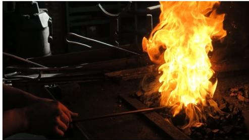
Mit dem Borax wird das Material im Feuer weiter erwärmt, bis es eine helle gelbe Farbe erreicht. (zwischen 1100°C und 1300°C erwärmt. Weihrauch 1995, S. 60).
