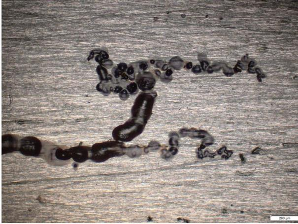
*Abbildung 68 Filiforme Korrosionserscheinung auf dem Coupon 3.IS mit Paraloid B44 Beschichtung 50x*
